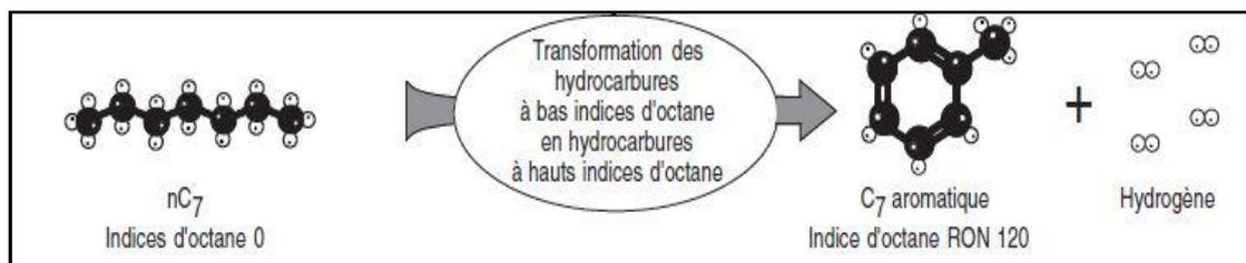
Figure I.5 : Transformation des hydrocarbures lors du reforming.
