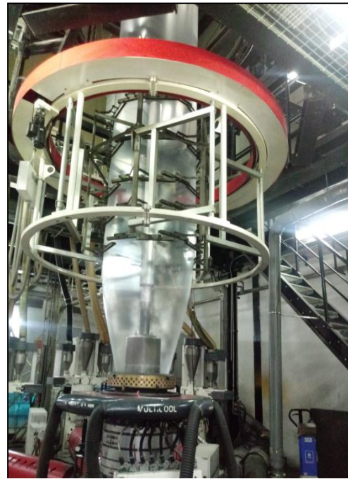
Figure II.2 : Photo d'une ligne d'extrusion gonflage.
