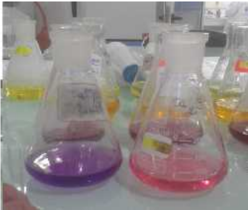
Figure IV-9 : Le résultat du virage de \text{Ca}^{2+} .
