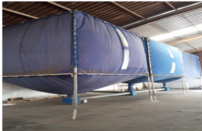
Figure I. 24 : Silos de pré-expansion.
