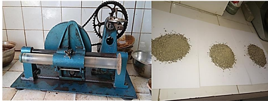
Figure II. 3 : Agitateur mécanique et 120 gr du sable.
