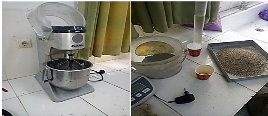
Figure II. 10 : Les constituants et le malaxeur automatique.
