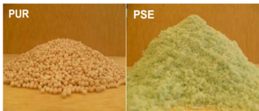
Figure I. 32 : Mousse de polyuréthane extrudé rigide et de polystyrène expansé utilisées.
