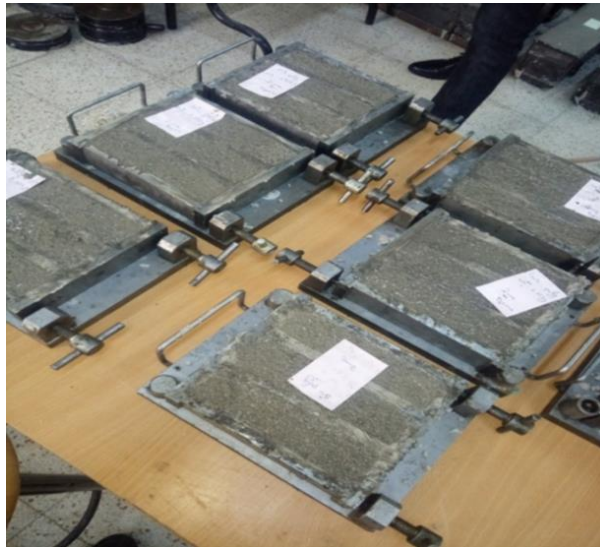
Figure II. 12 : Les éprouvettes prismatique (4x4x16) cm 3 .
