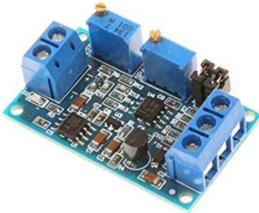
**Figure 4.7:** Module de conversion courant/tension
