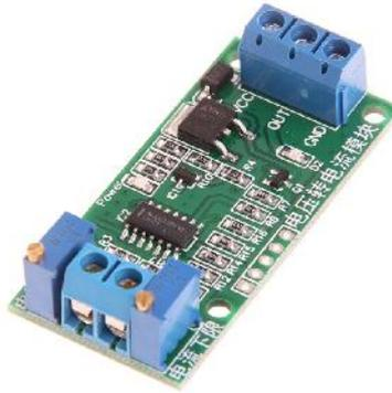
**Figure 4.6:** Module de conversion tension/courant
