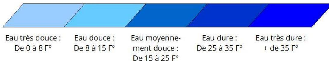
*Fig. III 5 : Evaluation de la dureté de l'eau par le titre hydrotimétrique.*
