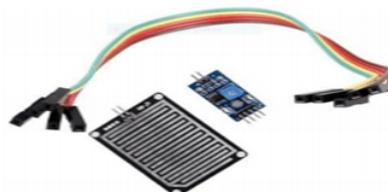
FIGURE 4.6 – Module capteur de détection de pluie..
