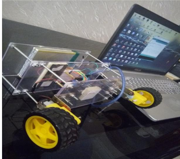
**Figure 4.21 :** Télécharger le programme vers l'Arduino.
