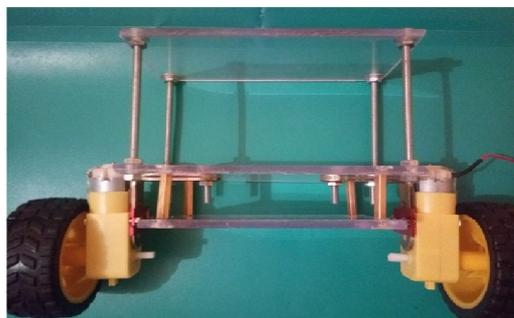
**Figure 4.11 :** Corps du robot.
