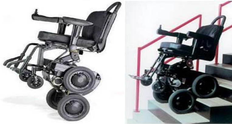
**Figure 1.24:** IBOT en position deux roues et en position descente escaliers.
