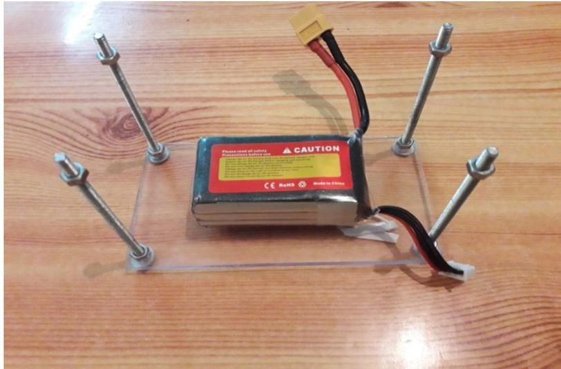
**Figure 4.10 :** Placement de la batterie dans un deuxième étage.
