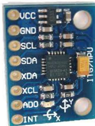
**Figure-2.9 :** Une carte GY-521 dotée de la puce MPU6050 (Accéléromètre et gyroscope). [18]
