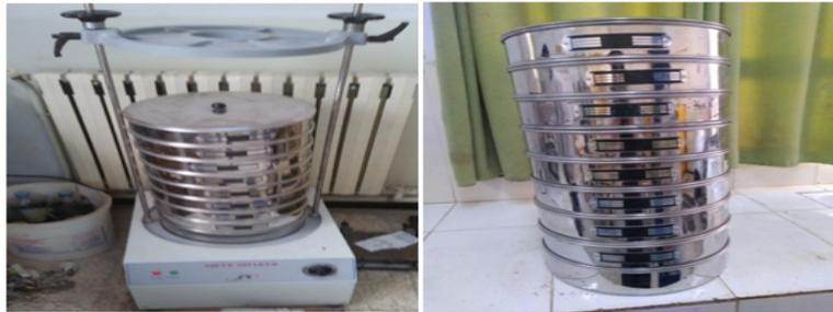
**Figure III. 2:** Tamiseuse et tamis de laboratoire.
