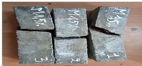
Figure III. 15:éprouvette après l'écrasement.
