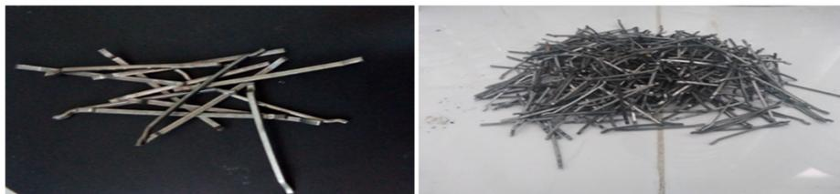
Figure III. 6: Déchets métalliques des pneumatiques.
