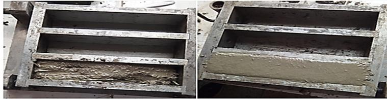
Figure III. 11: les étapes de remplissage de l'éprouvette.
