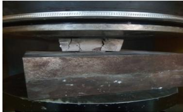
Figure III. 17: éprouvette après l'écrasement.
