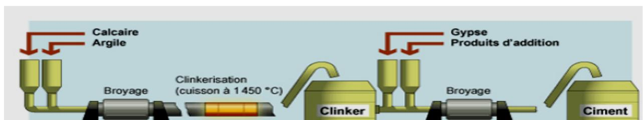
Figure II. 1:les étapes de fabrication de ciment [31].
