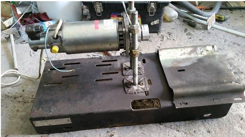
**Figure 5.3 :** Alternateur à aimant permanent.
