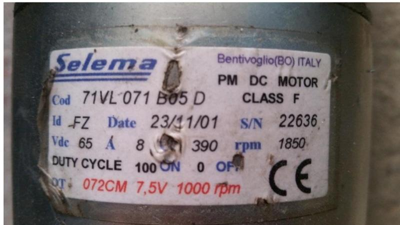
Figure 5.4 : Plaque signalétique de l'alternateur.
