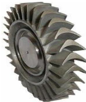
Figure 1.3 : Turbine axiale.
