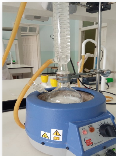
Figure II-10 : Montage de synthèse de nanocomposite PEHD-g-AM/MMT-Org par voie solvant.
