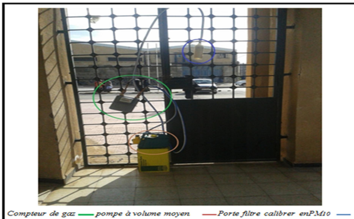
Fig.II.5. montage de prélèvement des PM10.
