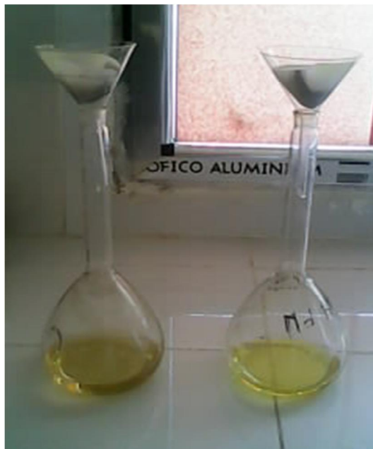
Figure IV.6 : préparation de l'eau régale
