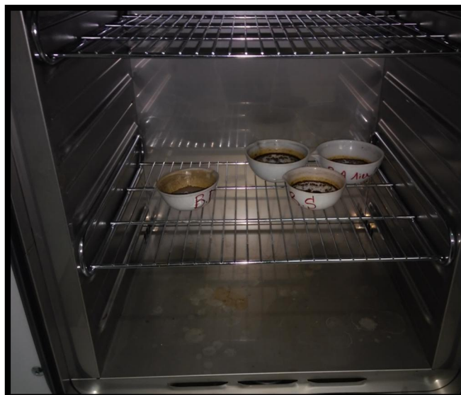
Figure IV. 3 : séchage des boues
