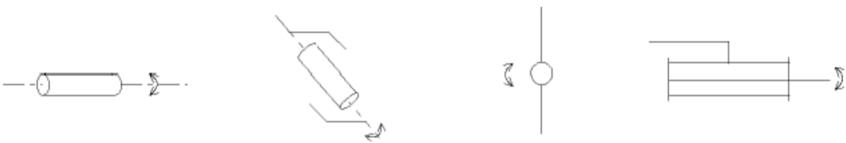
Figure (I.5) : Symboles de l'articulation rotoïde [11].
