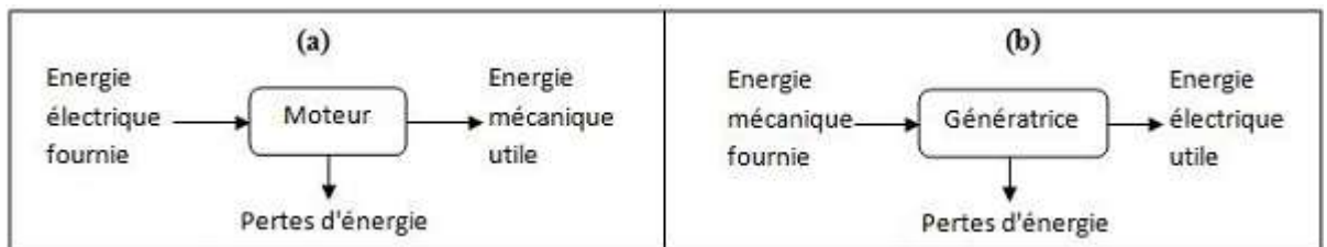
Figure (II.7) : Les modes de fonctionnement de la MCC [19].
