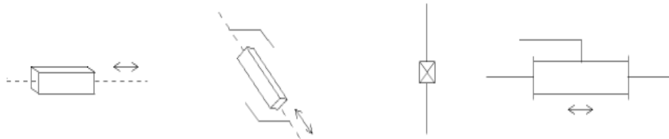
Figure (I.6) : Symboles de l'articulation prismatique [11].
