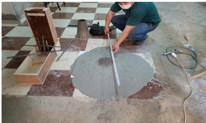
Figure IV.10. Essais d'étalement BAP (dosage 10% fillers de calcaires)
