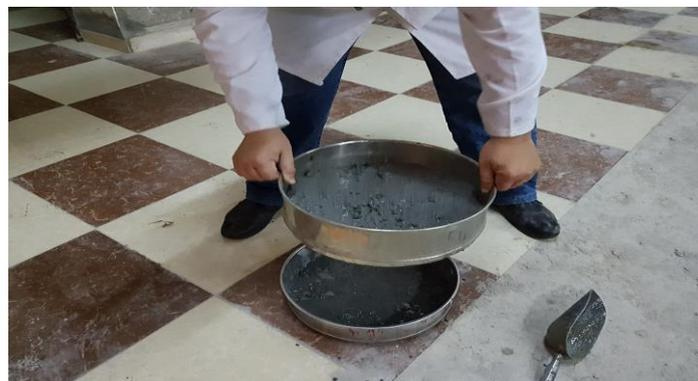
**Figure IV.8.** Essais de la stabilité au tamis BAP (dosage 10% fumé de silice)
