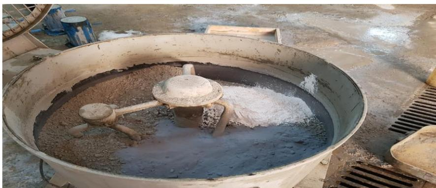
**Figure IV.13.** Malaxage du mélange (dosage 30% fillers de calcaires+30% de fumé de silice)
