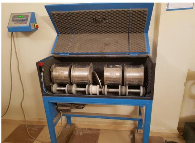
**Figure IV.5.** Essai de Micro Deval LABO LCTP BOUIRA
