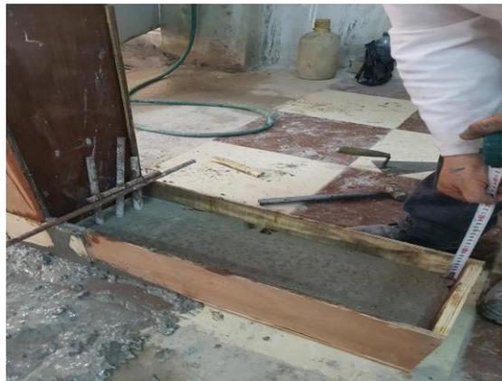
**Figure IV.7.** Essai boîte en L BAP (dosage 10% fumé de silice)
