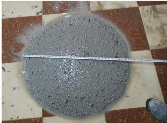
**Figure IV.6.** Essai d'étalement BAP (dosage 10% fumé de silice)
