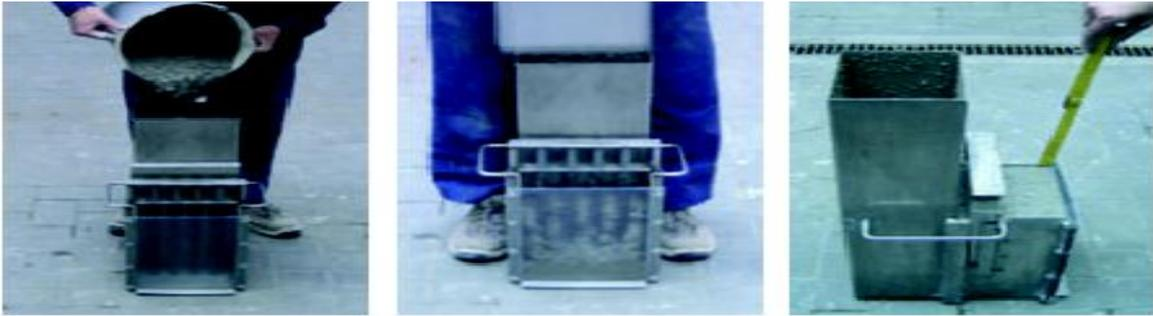
Figure III.4 Capacité de remplissage.
