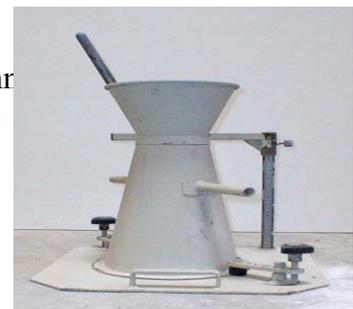
Figure III.2 cône d'Abrams
