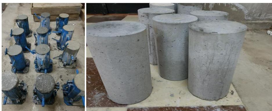
**Figure IV.14.** Aspect des éprouvettes du mélange BAP (dosage 30% fillers de calcaires+30% de fumé de silice).
