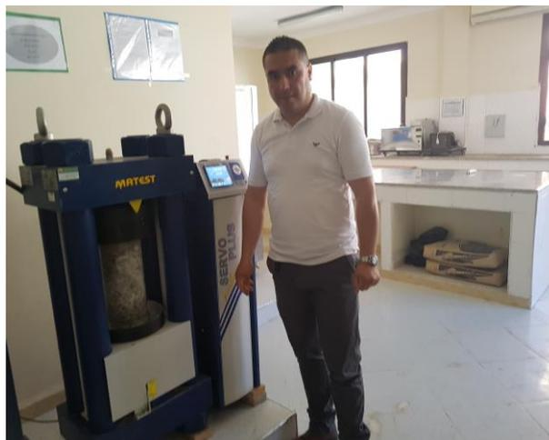
**Figure IV.9.** Résistance à la compression BAP (dosage 10% fumé de silice)
