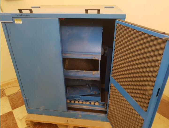
Figure IV.4. Essai de Los Angeles LABO LCTP BOUIRA
