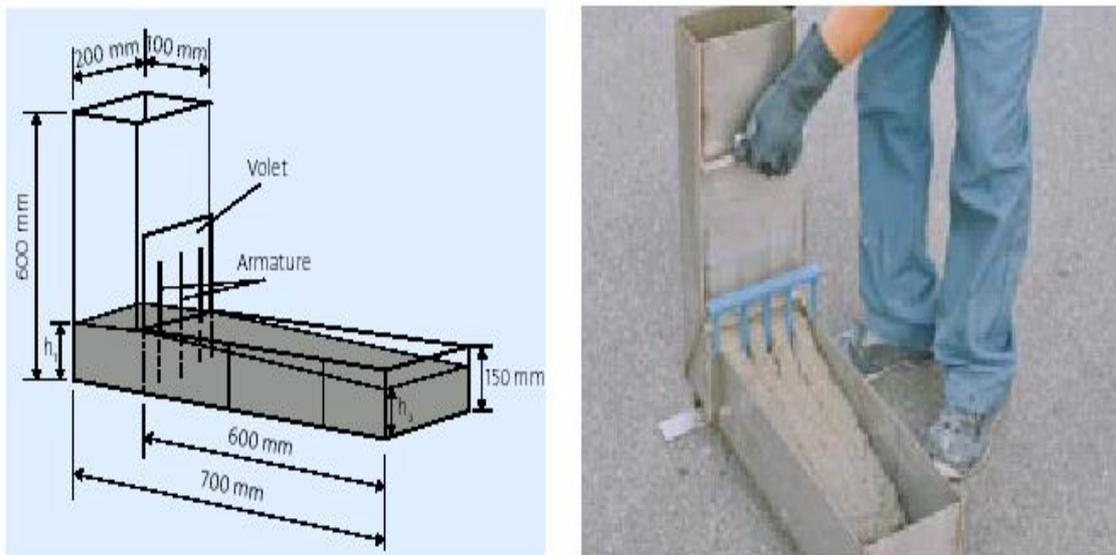
Figure. III.6 Schéma de la boîte en L
