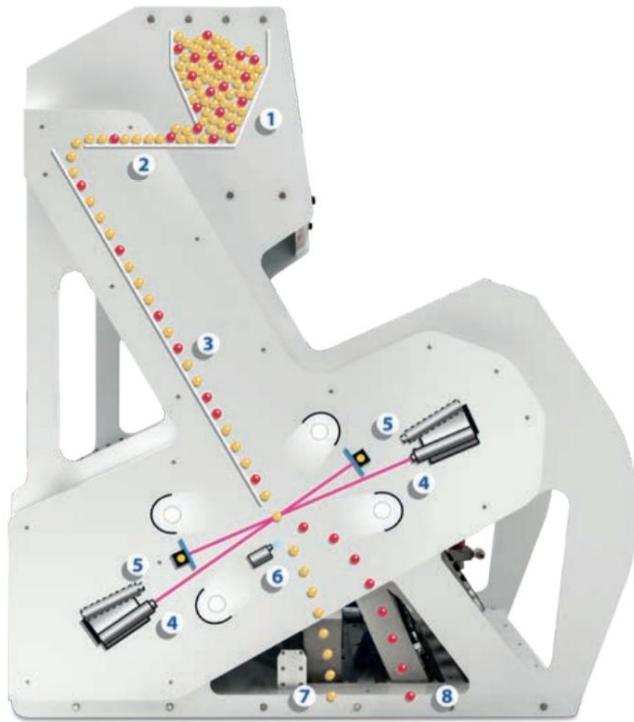
Figure III.1: principe de trieur optique
