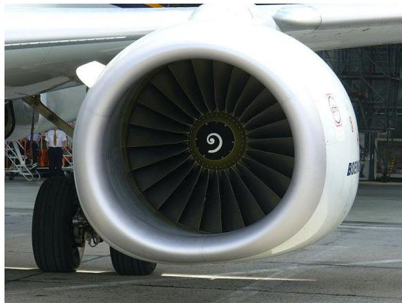
Figure (II.2) : L'entrée d'air. <sup>[5]</sup>
