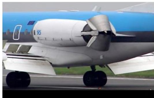
Figure (II.6) : schéma d'inverseur à obstacle. <sup>[5]</sup>
