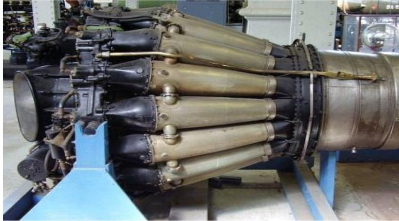
Figure (II.4) : Chambre de combustion tubulaire. <sup>[3]</sup>
