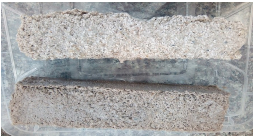
Figure III. 18 : éprouvette dans l'acide 28j[ H_2SO_4 (5%) ]
