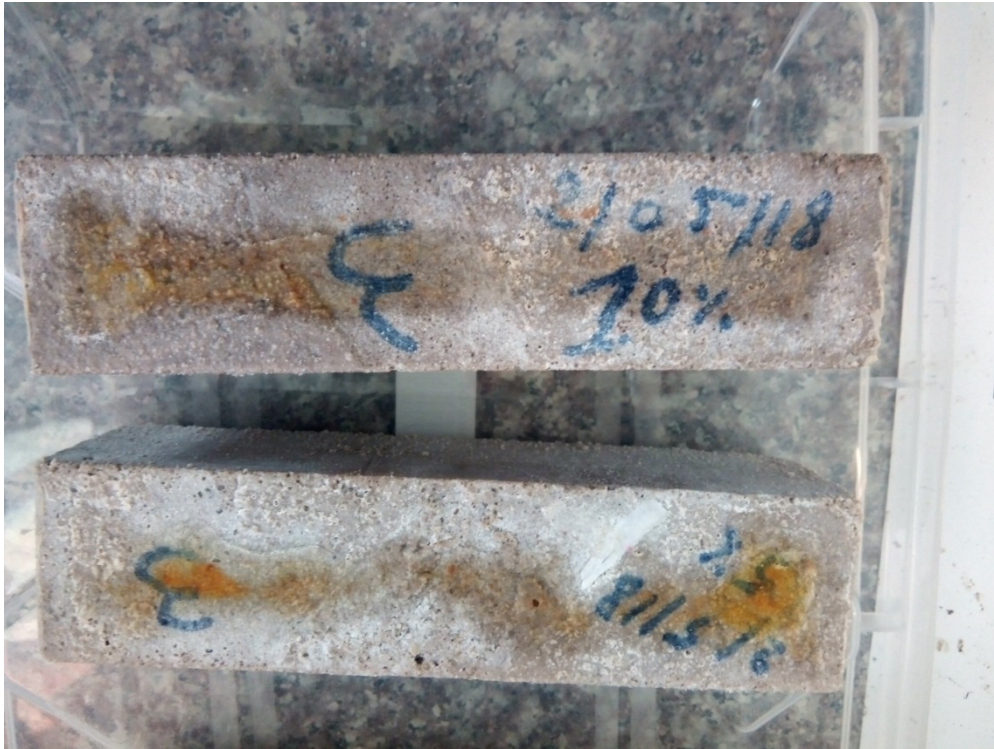
Figure III.13; photo éprouvette soumises 2% H 2 SO 4 durant 28jours
