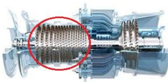
Figure I.6 : section compresseur.
