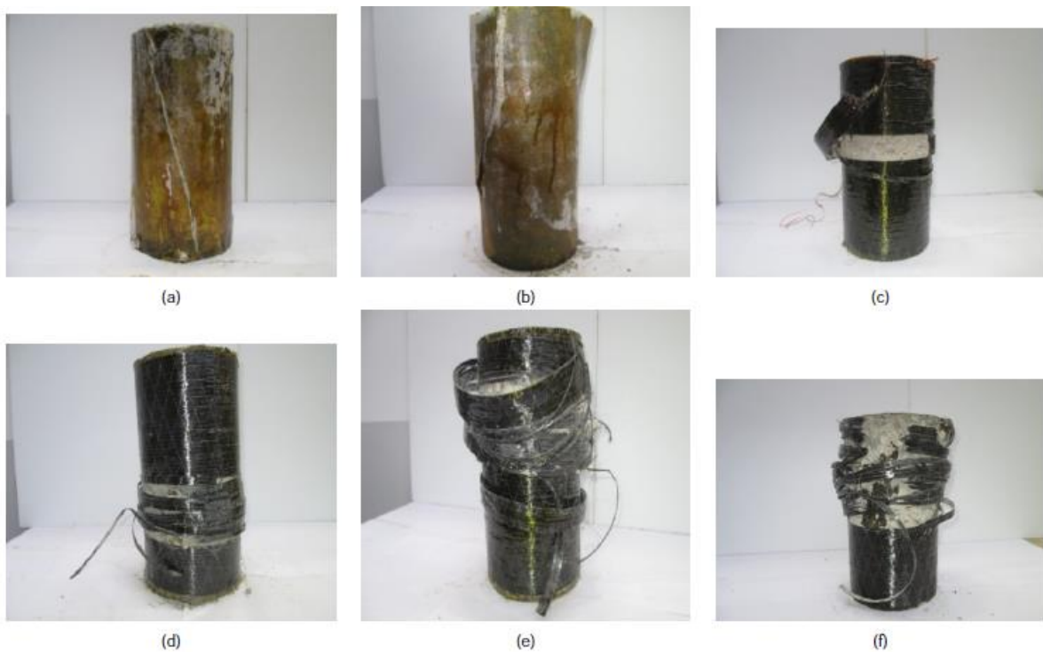
Figure II. 9. Modes de rupture typiques des éprouvettes renforcées de PRF : (a) et (b) rupture des enveloppes en PRFV de haut en bas, (c) rupture annulée des enveloppes en PRFC, (d) rupture localisée en
