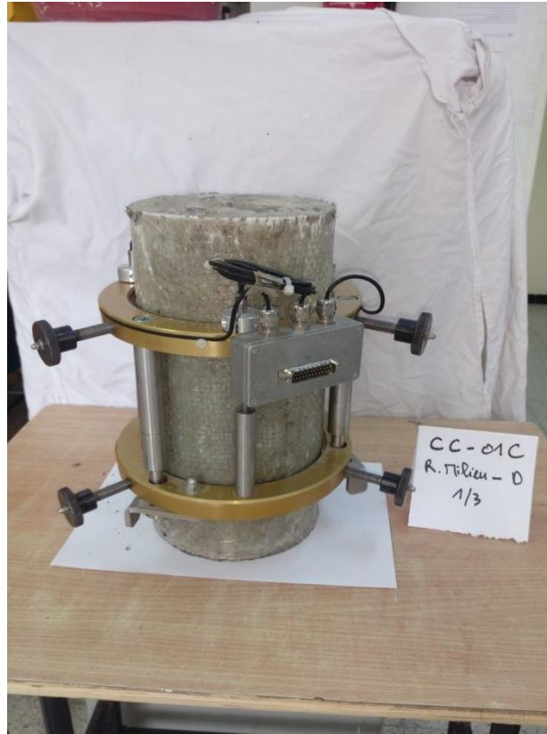
Figure III.17. Mode de rupture du cylindre confiné 'CC 1C PC'
