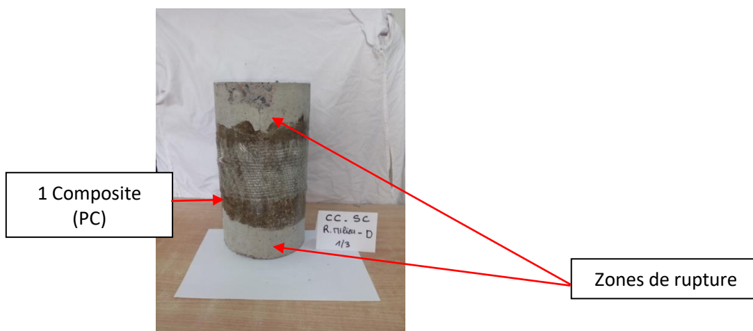
Figure III.15 : Mode de rupture du cylindre confiné 'UC 1C PC
