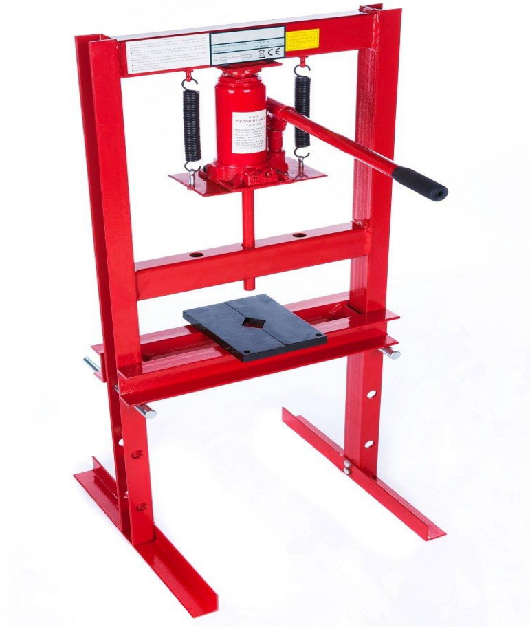
Figure I.3 : la presse hydraulique à base d'un cric hydraulique de 6T.
