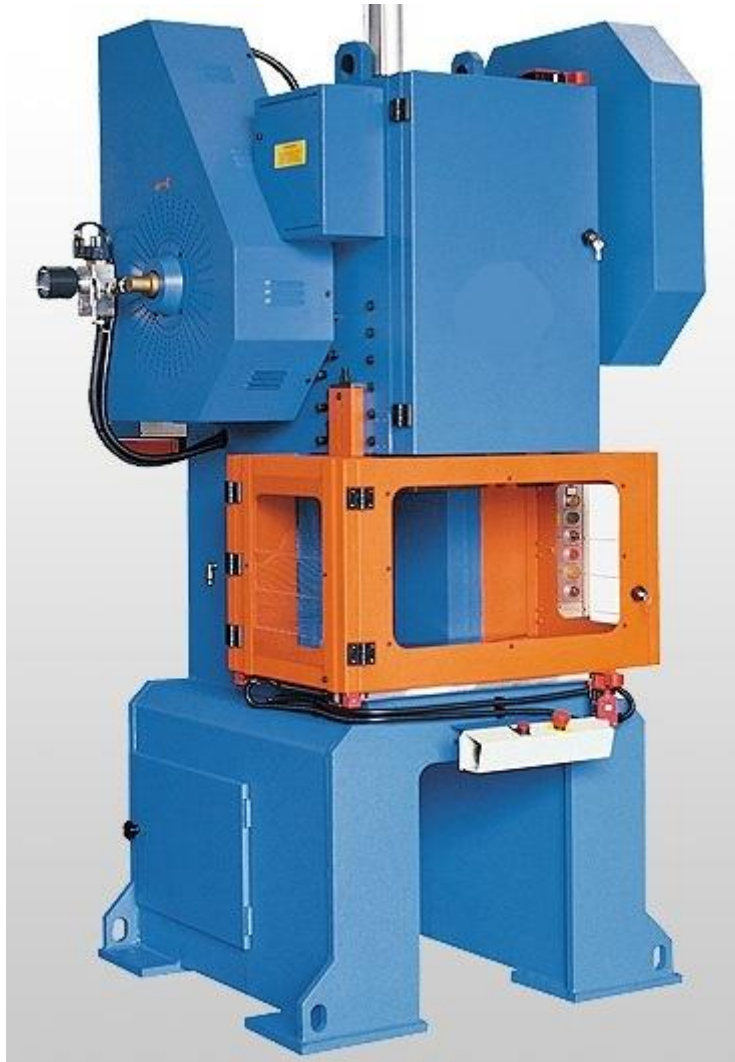
Figure I.6 : la presse mécanique excentrique.
