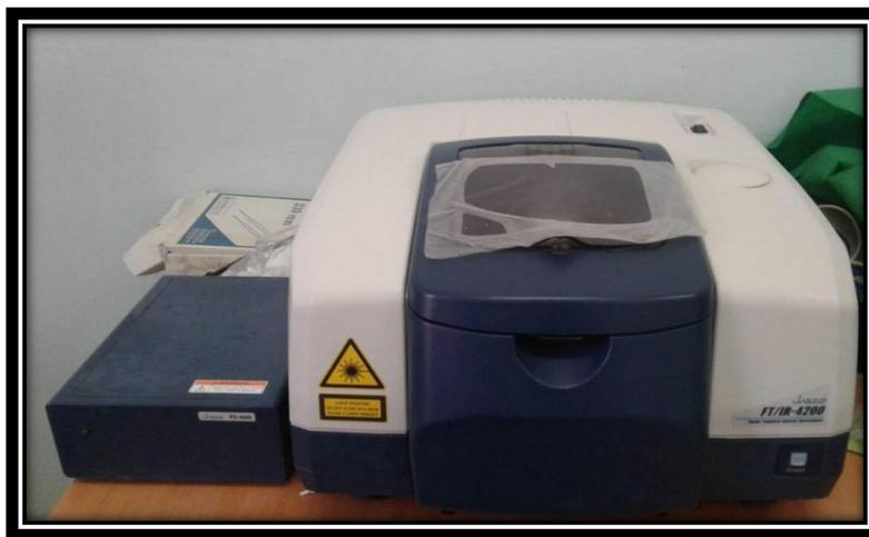
**Figure 20** : Appareil Spectroscopie IR.
