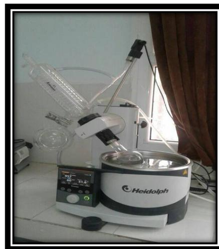
**Figure 15** : Appareil Rotavapor
