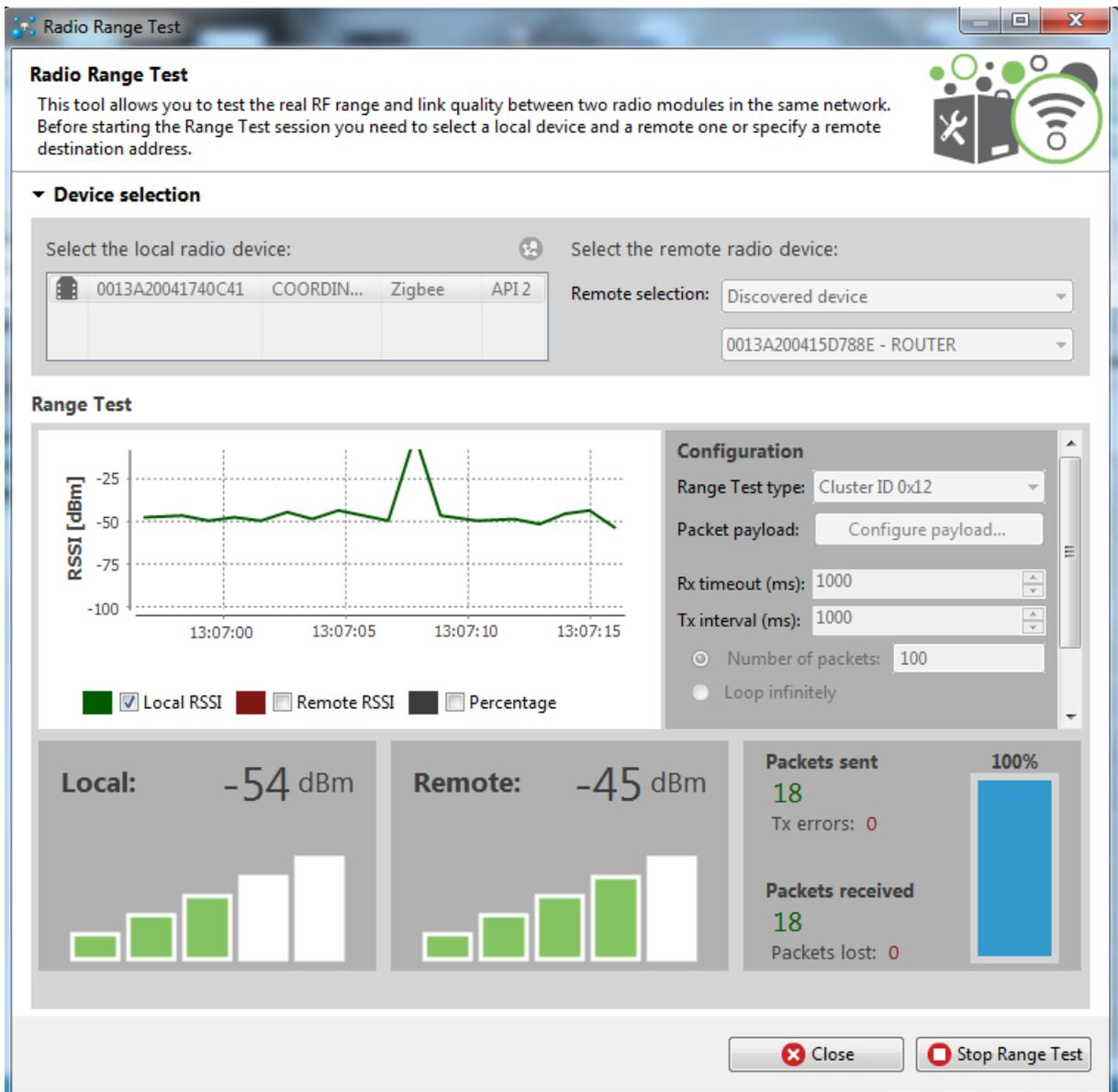
Figure III. 7 : Application de mesure RSS sous Xctu (test range).
