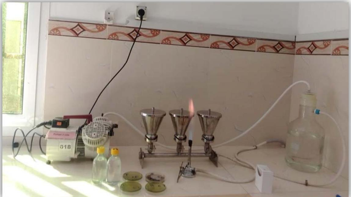
**Figure III-4:** la rampe de filtration
