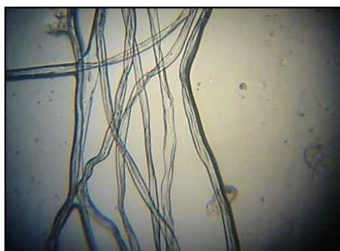
Figure III.1 : Vue microscopique des fibres de la gaze.
