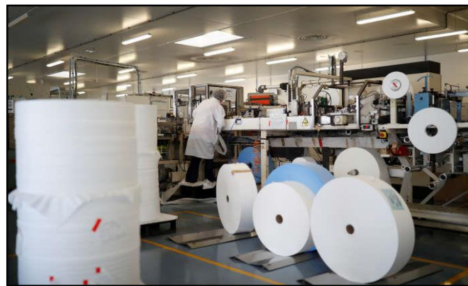
Figure II.3 : Installation des rouleaux dans la machine de coupage et pliage (plieuse).
