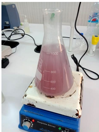
Figure n° 20 : Homogénéisation des composants de milieu sur un agitateur plaque chauffante.
