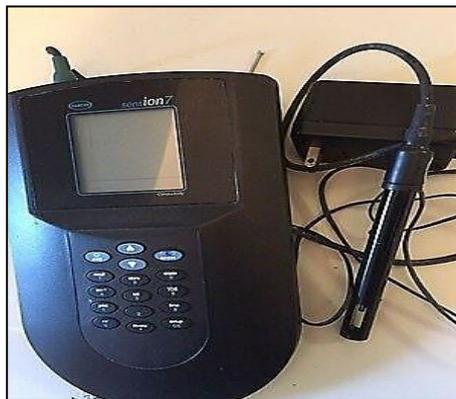
Figure IV- 3: Conductimètre sensION7
