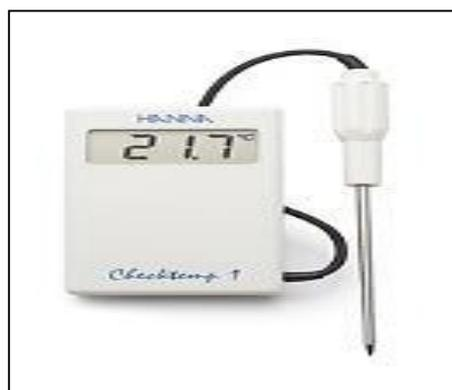
Figure IV- 1: Thermomètre HANNA instruments
