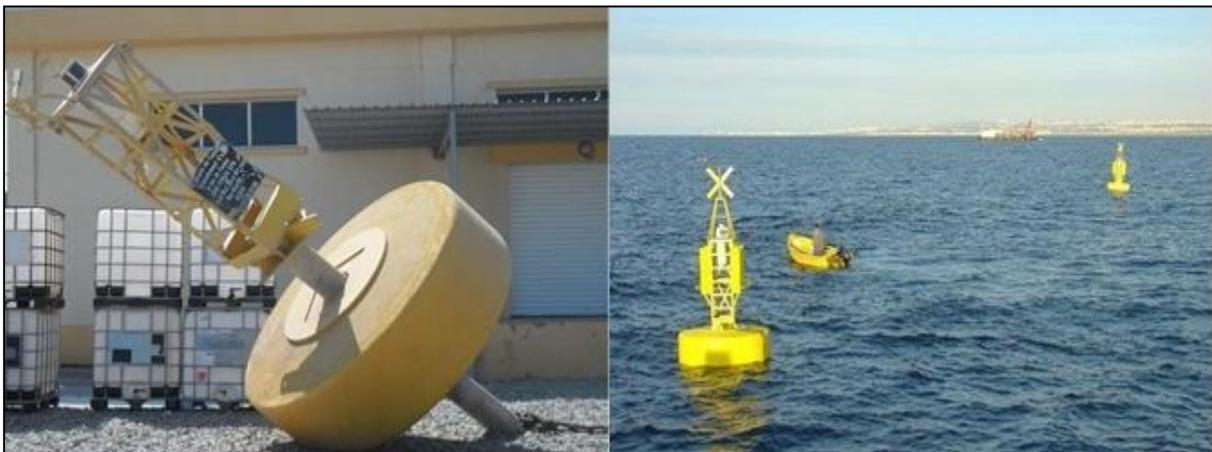
Figure III- 1: Bouées de signalisation indiquant le positionnement de la conduite d'aspiration d'eau de mer.
