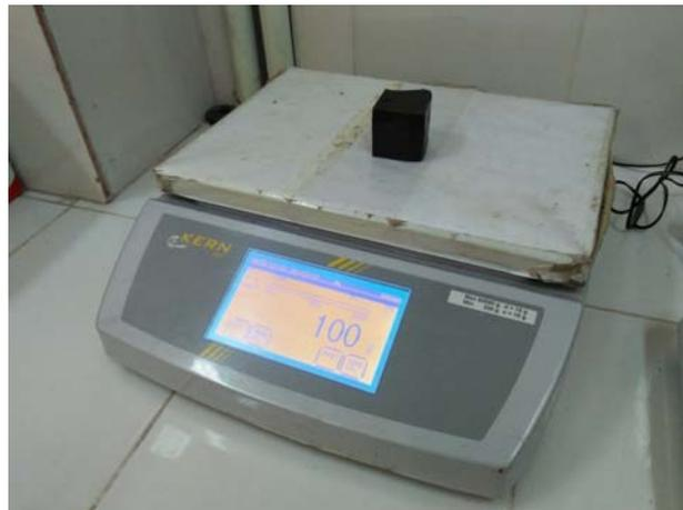
**Figure IV. 7 : Masse avant de plonger l'échantillon dans l'eau.**
