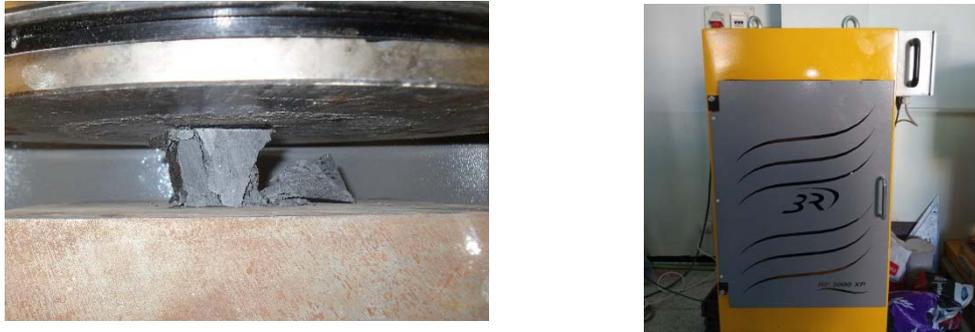
**Figure IV. 6: Appareil d'essai compression.**
