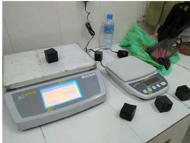
Figure IV. 9 : Essais d'absorption.
