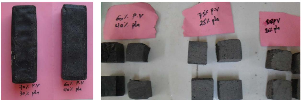
Figure IV. 5 : éprouvettes d'essais physico-mécaniques.
