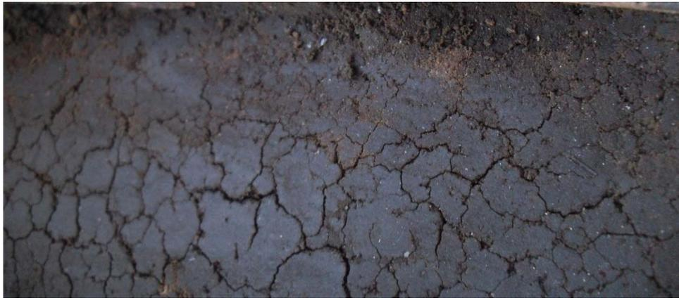
Figure IV. 4 : Surface fissurée des éprouvettes du mélange (80 % poudre de verre et 20 %plastique).
