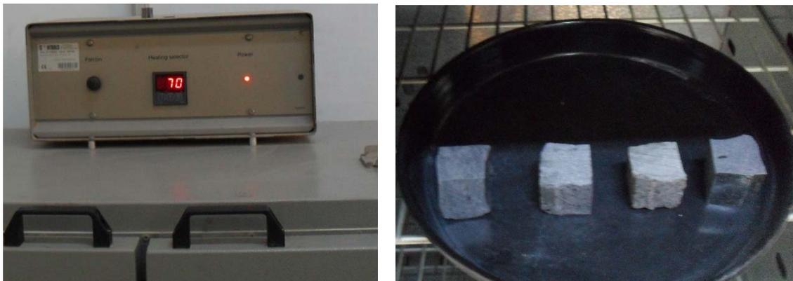
Figure IV. 10 : essais thermiques à l'environnement chaud.
