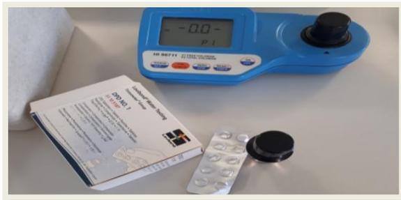
**Figure IV.12 :** Appareil d'analyse de chlore
