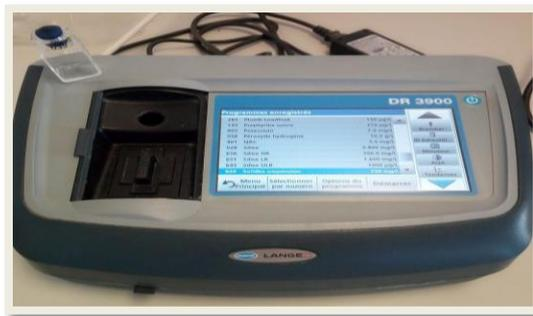
Figure IV.11 : Spectrophotomètre
