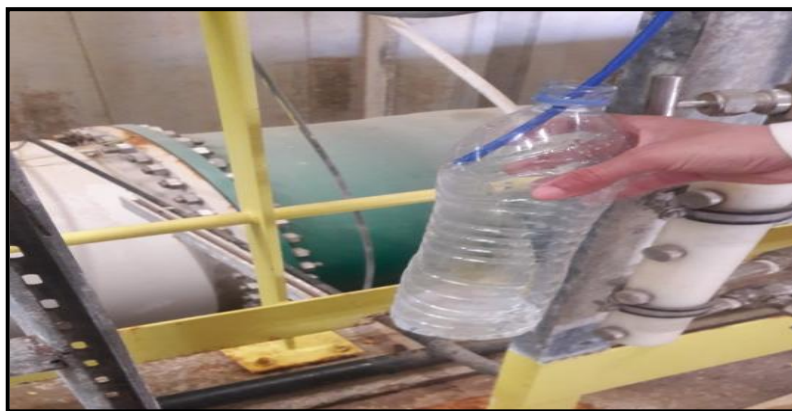
Figure III.3 : point de prélèvement de l'eau rejetée (saumure).
