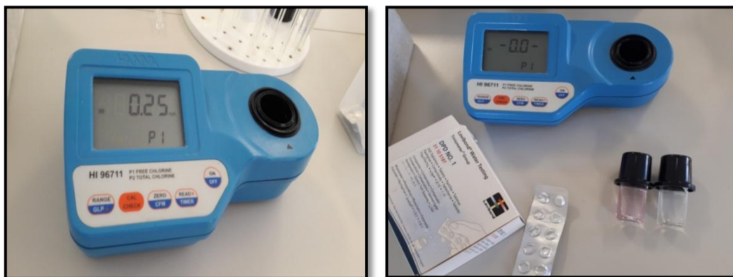
Figure III. 11 : appareil de mesure le chlore libre.
