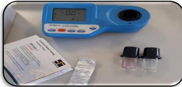
Figure III-5: Colorimètre
