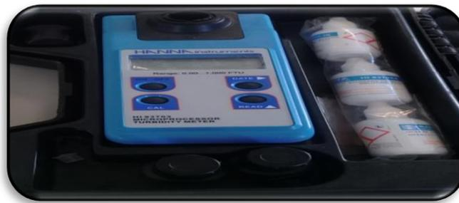
Figure III-4: Turbidimètre
