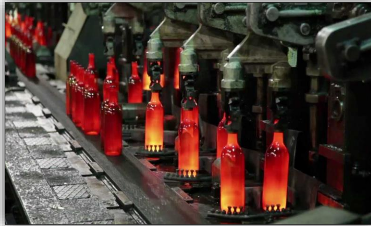
Figure II. 10: Formage du verre dans une machine IS [15].
