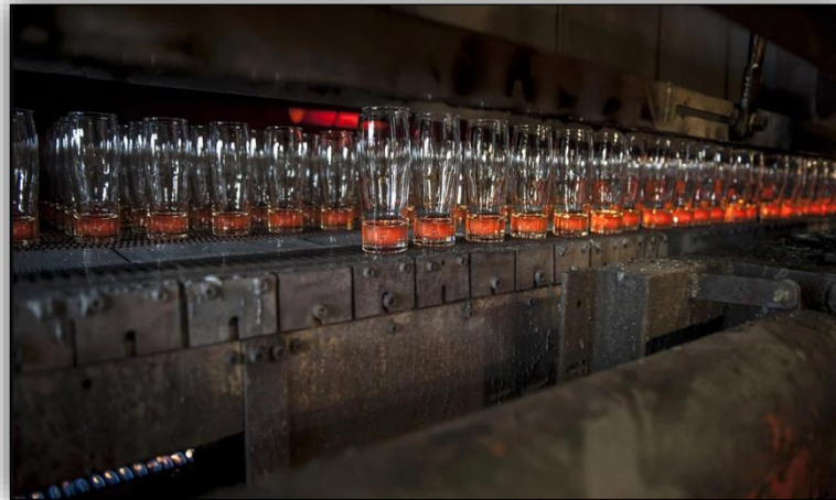
Figure II. 11: Recuison des produits en verre [16].
