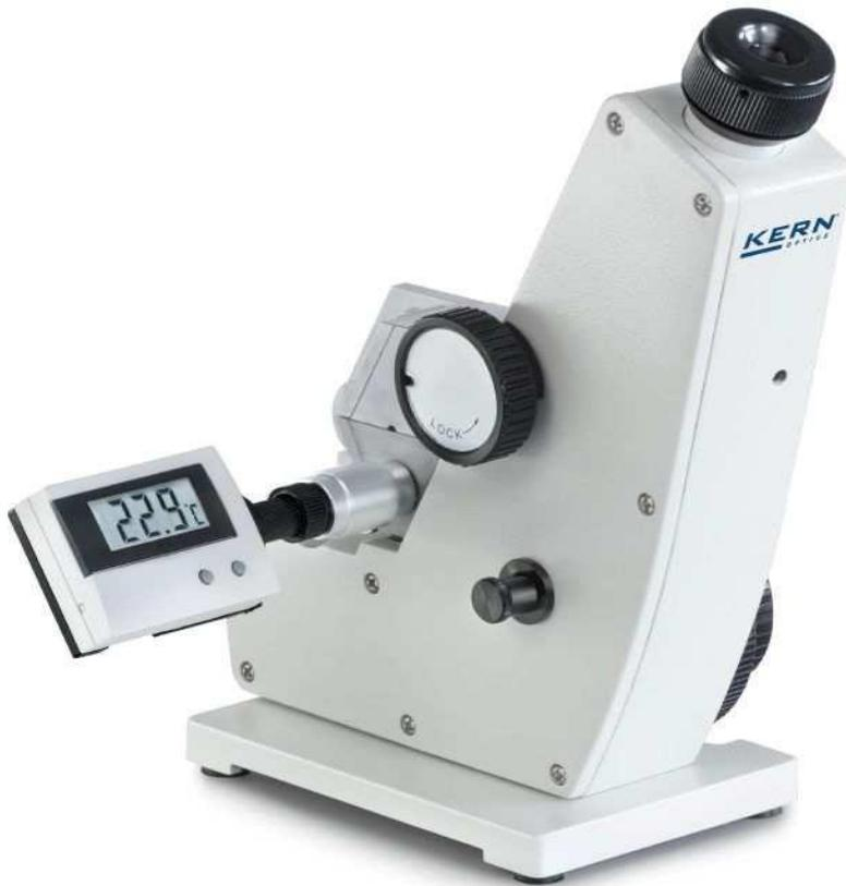
Figure II 6: refractomètre type ABBE
