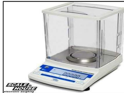
Figure II 2 : balance de précision
