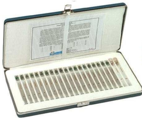
Figure II 8: Echelle de viscosité Gardner
