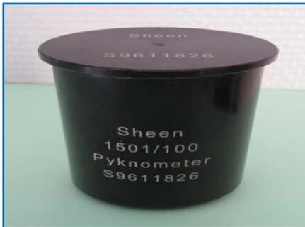
Figure II 1:pycnomètre
