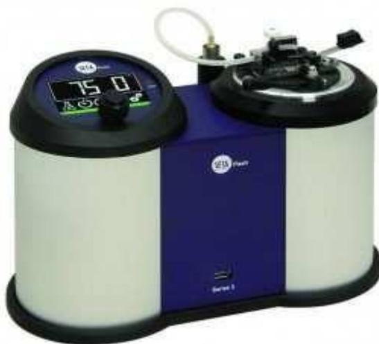
**Figure II 7:** Appareil du point d'éclair
