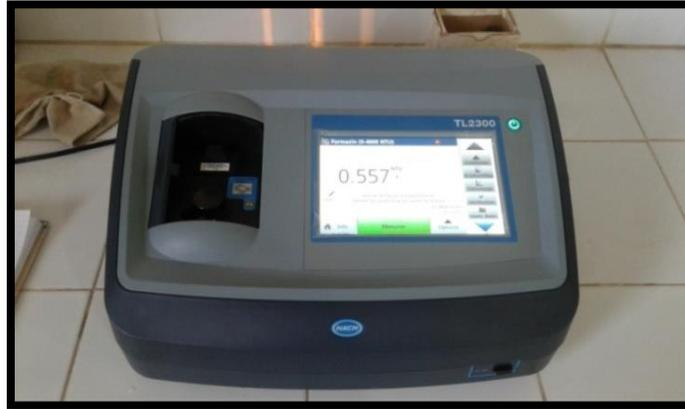
*Figure II.3 : Turbidimètre.*
