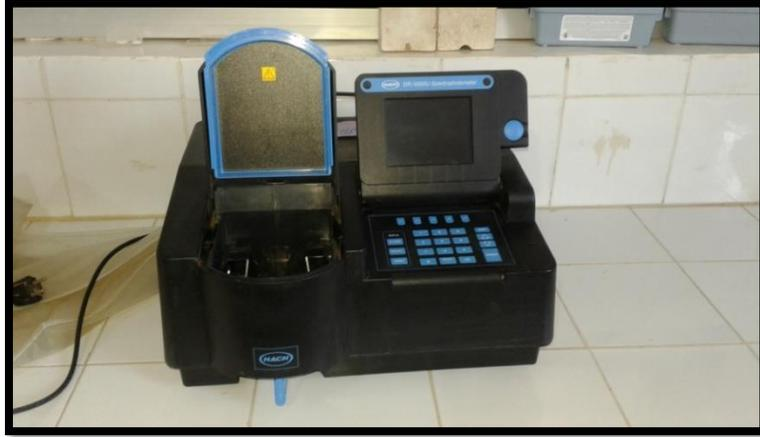
*Figure II.6 : Spectrophotomètre UV visible.*
