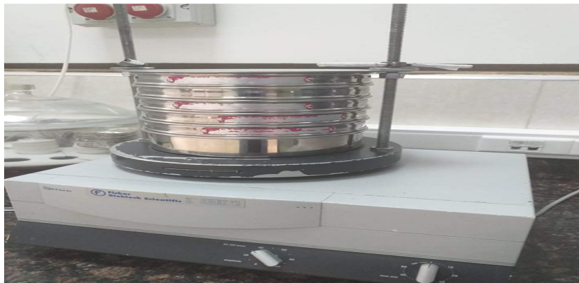
Figure 3 : Technique de détermination de la granulométrie (Planchister) (Originale).
