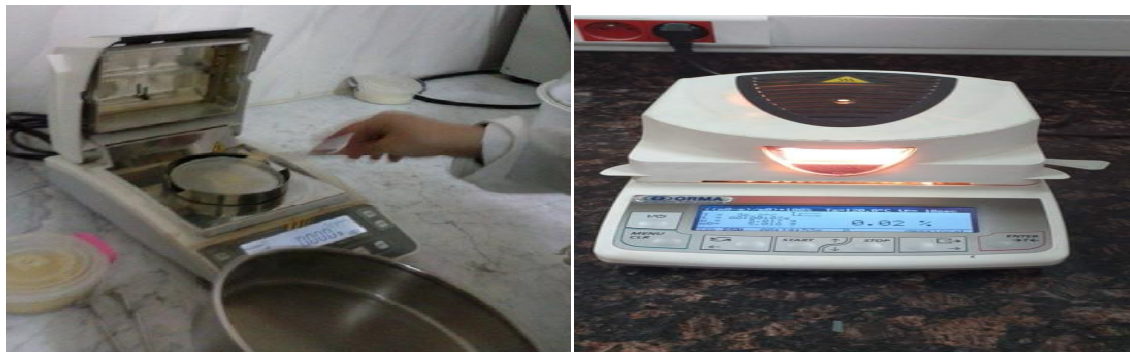
Figure 4 : Détermination de l'humidité de la semoule (Originale).
