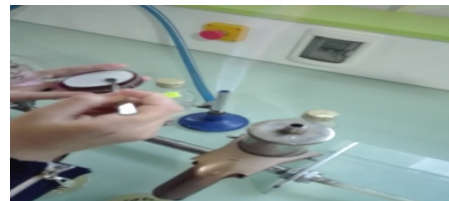
Déposer la membrane sur le milieu sélectif (ONDO)
