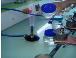
Stériliser et remplir La rampe de filtration avec L'eau à analyser.
