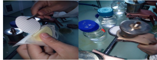
Mettre en place une membrane à l'aide d'une pince stérile
