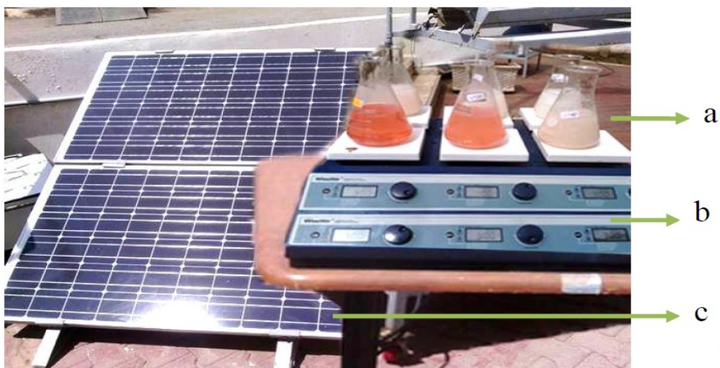
Figure II.1 : Dispositif expérimental de la dépollution de l'eau par photocatalyse solaire : a) Solution (colorant + catalyseur) en agitation. b) agitateur magnétique. c) panneau photovoltaïque.
