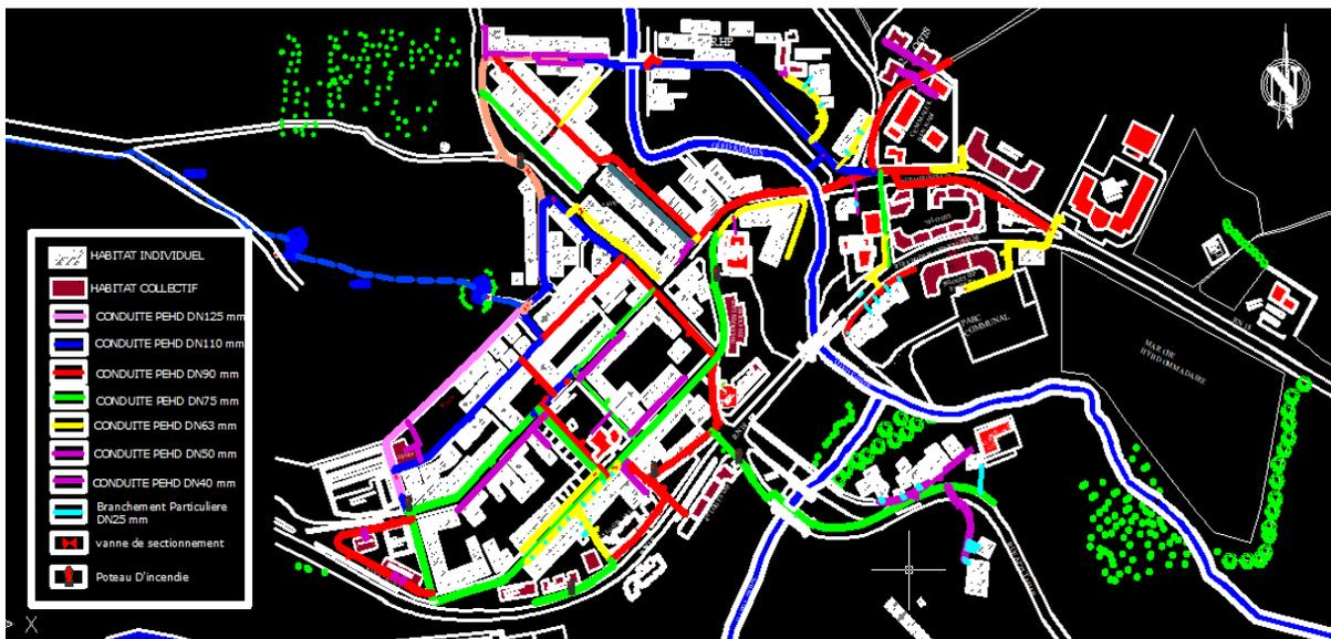
Figure 7 : Plan Autocad du réseau d'AEP existant de la ville d'Ain El Hadjar
