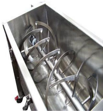
**Figure 10 :** Mélangeuse horizontale
