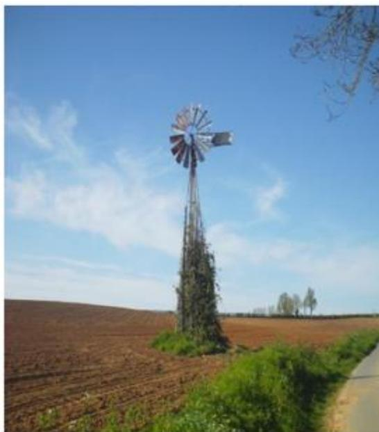
**Figure 2. 1** : éolienne de pompage
