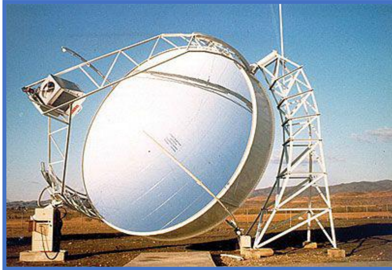
Figure (I.16) : Capteur parabolique avec moteur Stirling[16].
