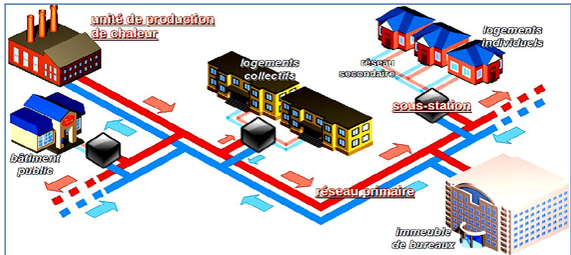
Figure I.23 : Architecture d'un réseau de chaleur [25]
