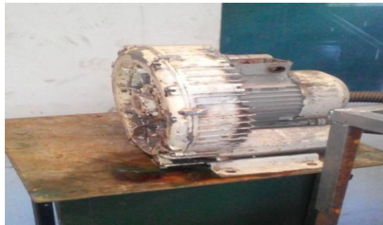
Figure II.9 : Le souffleur (pompe).
