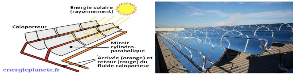
Figure.I.3 : schéma d'un concentrateur cylindro-parabolique.
