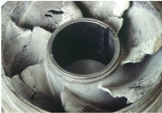
**Figure III.3 :** Roue soumise à cavitation.
