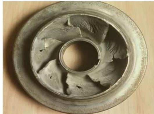
**Figure III.4 :** Effet de la cavitation sur la roue d'une pompe centrifuge [19].
