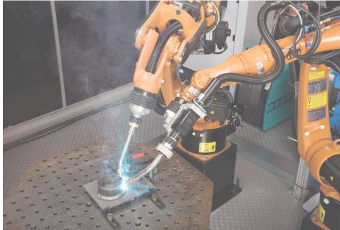
Figure I.8. Manipulateur automatique (kuka-robot de soudage à l'arc). [10]
