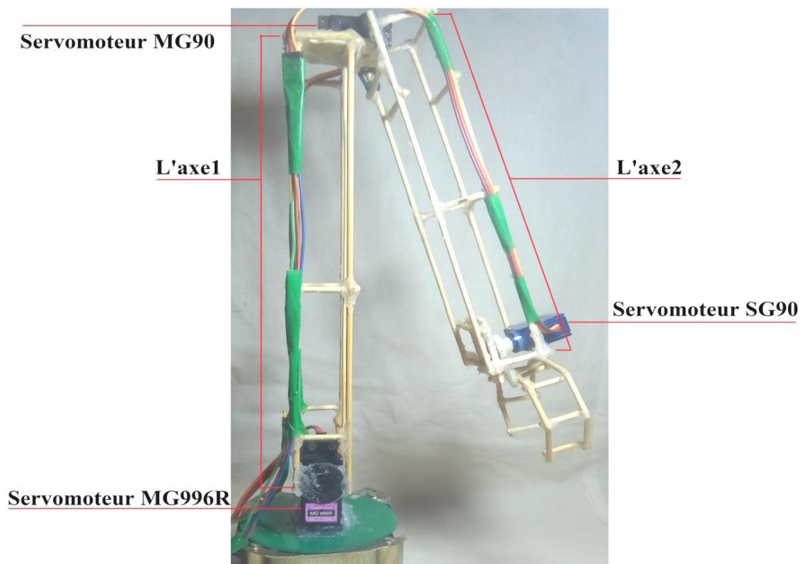
Figure III.5. Image réelle de l'axe 1 et l'axe 2.
