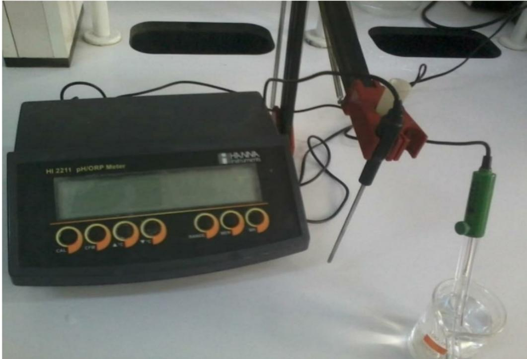
**Figure II-3: pH mètre utilisé pour les essais de coagulation-floculation.**
