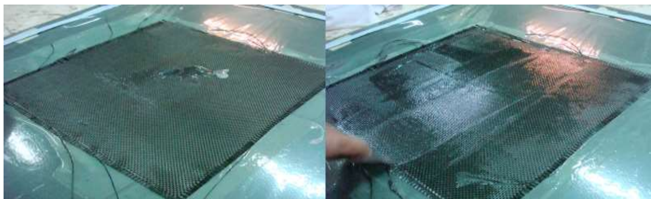
Figure 30:Résine coulée sur le tissu à l'aide d'un rouleau.
