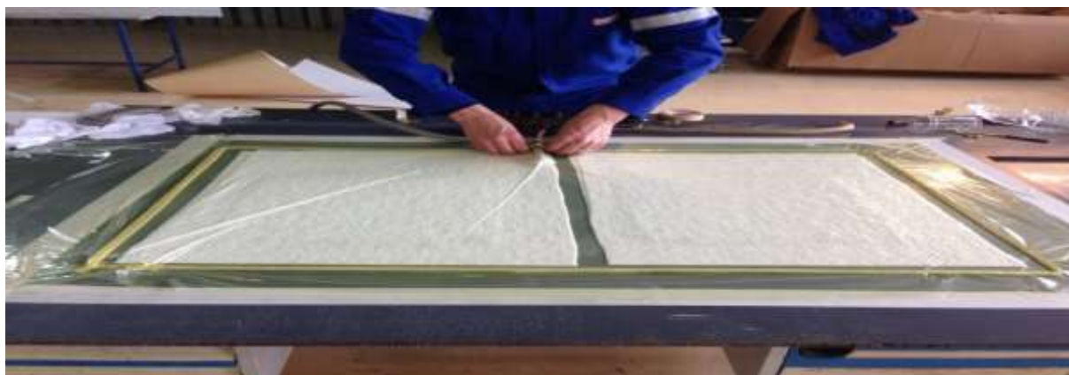
Figure 32: Stratifié branché avec une pompe à vide.
