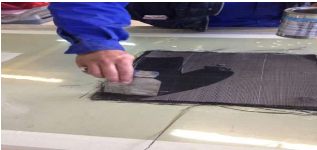
Figure 35: Dépôt de la résine sur le tissu de carbone
