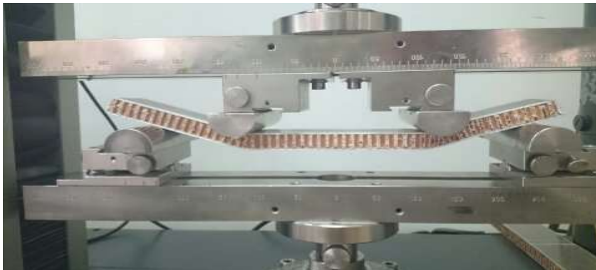
Figure 84: Essai de flexion 4 point pour l'éprouvette à âme nid d'abeille et peaux verre/époxy.
