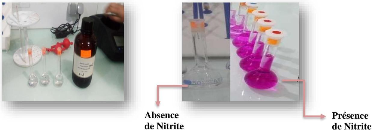
**Figure 08 :** Dosage de Nitrite ( $\text{NO}_2^-$ ).
