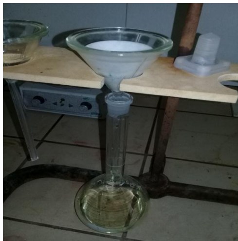
Figure IV.3 : Protocole de filtration
