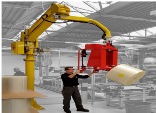
Fig. 1.10 – Manipulateur à commande manuelle.
